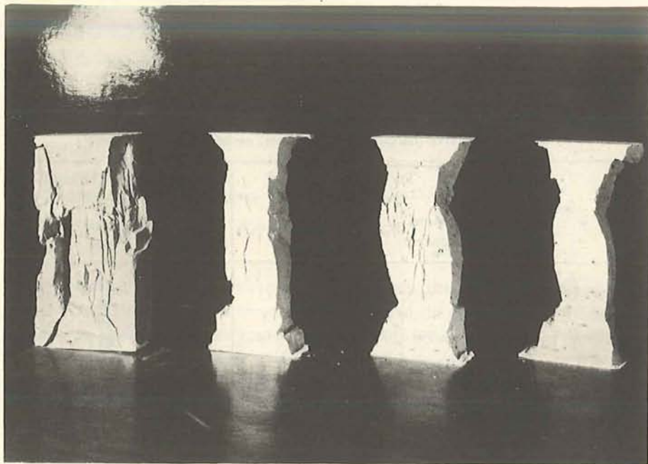
Fig. 1. Flamsten efter trykprøvning på højkant. Common bricks after compression test applied edgewise.
