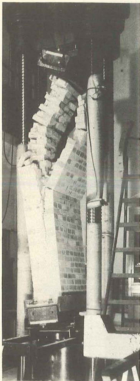
Fig. 12 og 13. Karakteristiske billeder af mure ved pludselig brud. Typical pictures of walls with sudden break-down.
